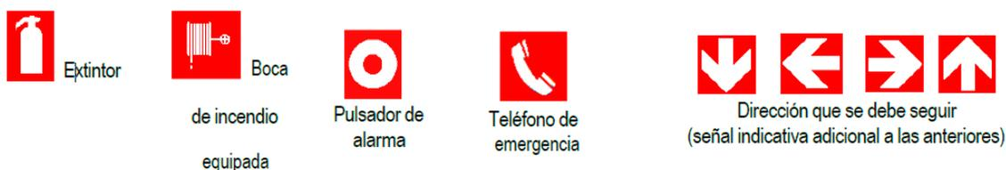
Esta señalización deberá fijarse en los lugares adecuados y ser duradera. Las señales relativas a los equipos de lucha contra incendios deberán ser visibles en todo momento, por lo que, ante un posible fallo del alumbrado normal, dispondrán de fuentes luminosas incorporadas interna o externamente, o bien serán fotoluminiscentes (en cuyo caso, las características de emisión luminosa de las señales se ajustarán a lo establecido en la norma UNE 23035-4).
